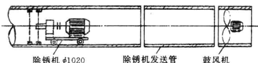
图 68.1-7 除锈机工作示意图
