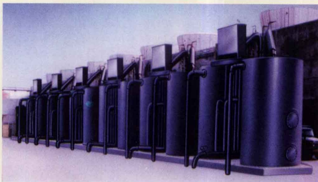
广东茂名三十万吨乙烯第一循环水站 (1200吨/小时)
