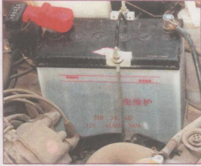
图 1.2-10 汽车中的铅蓄电池
