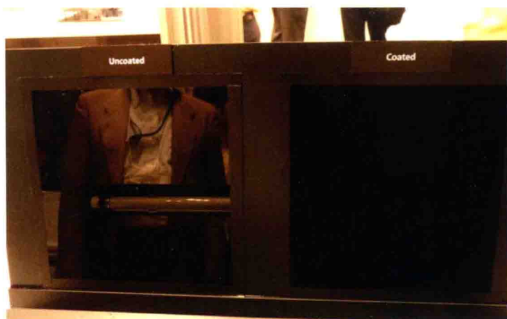
▲彩图33 防反射膜涂抹前后对照（左图为未涂覆，右图为已涂覆）
