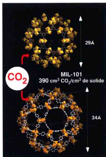
▲彩图36 MIL-101两种笼形结构是优良的二氧化碳捕获体
