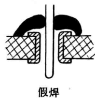
图 1-11 假焊与虚焊的焊点
