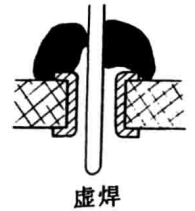
图 1-11 假焊与虚焊的焊点
