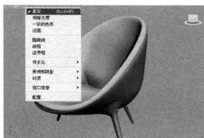
2 “明暗处理”方式。此种显示方式的视图中，物体没有灯光效果。
