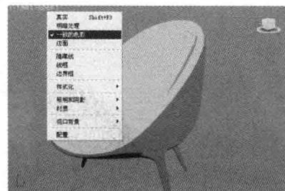
4 “边面”显示方式。在物体显示的基础上以线框构造形式显示，但必须与“真实”、“明暗处理”和“一致的色彩”一起使用。
