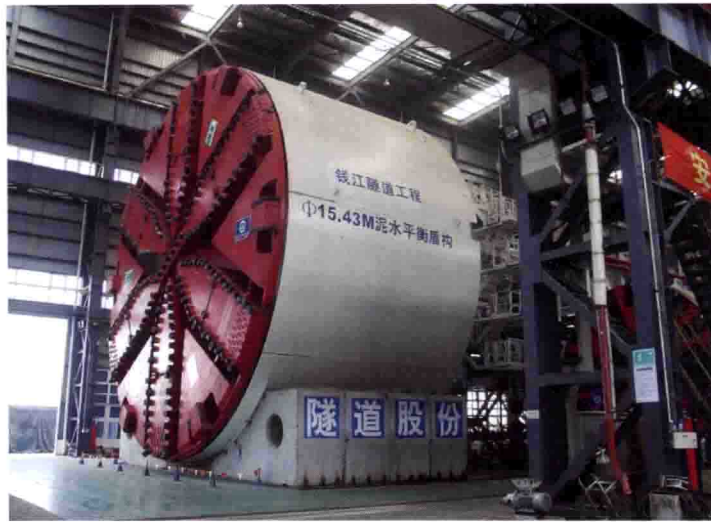
钱江隧道通泰号世界最大盾构机之一
