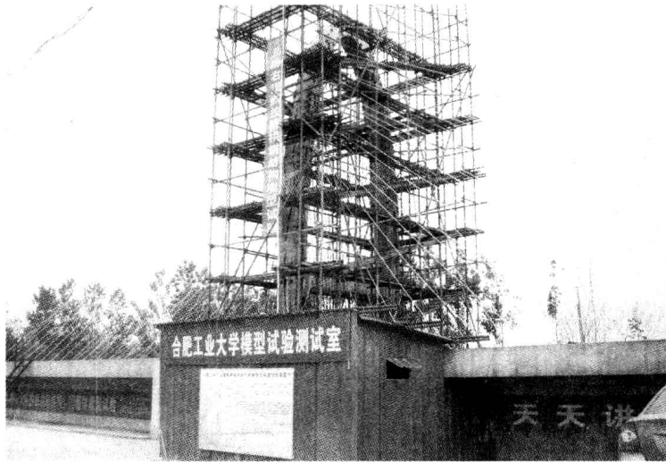
图 1-3 马鞍山长江大桥右汊斜拉桥拱塔结构缩尺模型试验
