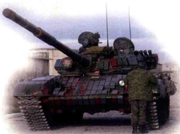
图 T-72 的倾斜反应装甲
