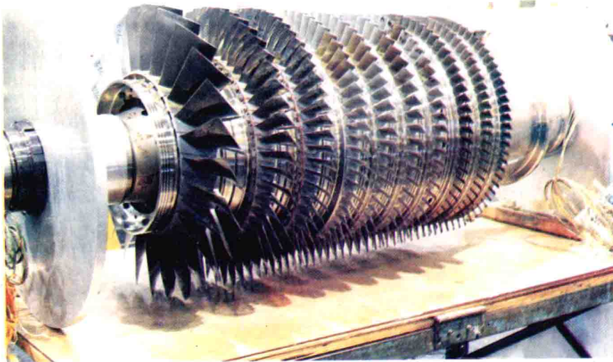
P & W 公司高效节能 发动机高压压气机 转子组件
