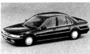
第四代雅阁于 1989 年秋季推出。其轴距 107.1 in，总长为 184.8 in，较大的尺寸使该新款雅阁进入了中级轿车的行列。由本田美国研发公司设计开发的一款新旅行车型加入到双门和四门版雅阁的行列中。采用的新型 2.2 L 四缸发动机可提供 130 hp 的功率（EX 版）。变速箱选择包括 5 速手动和带运动换挡模式的 4 速自动。
