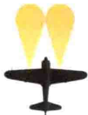
A6M2 “零”式 2×20毫米 (0.79英寸) 航炮 2×7.7毫米 (0.303英寸) 口径机枪
