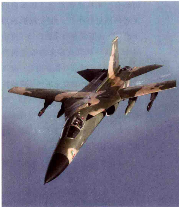
上图：如今仍在澳大利亚皇家空军服役的F-111（已于2011年12月2日退役）是第一架具备低至距地面60米（200英尺）高度自动地形跟随能力的攻击机。
