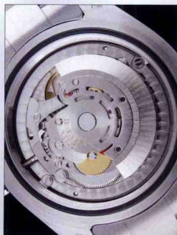
由通用机芯改制的假劳力士机芯，有改装的红色换向轮和双摆夹板等貌似真货的特征，但细看板路、细节等，和真货完全不同。
