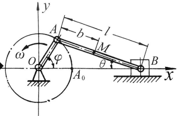
曲柄连杆机构由曲柄连杆及滑块组成，如上图所示，当曲柄  $OA$  绕  $O$  轴转动时，通过连杆  $AB$  带动滑块  $B$  作直线往复运动。已知曲柄  $OA$  长为  $r$ ，以均匀角速度  $\omega$  绕  $O$  轴转动，即  $\varphi = \omega t$ ，连杆  $AB$  长为  $l$ 。
