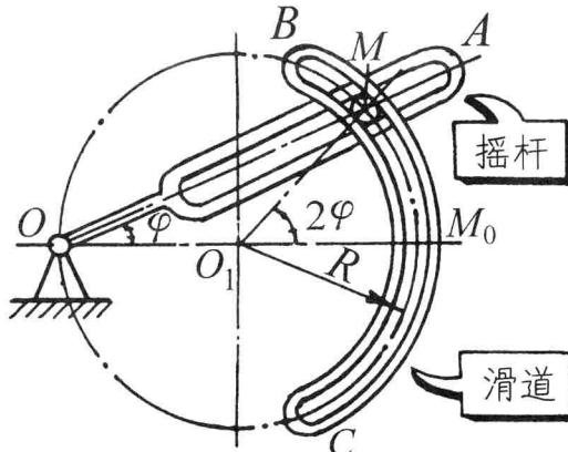
摇杆滑道机构中的滑块  $M$  同时在固定的圆弧槽  $BC$  中和在摇杆  $OA$  的滑道中滑动，如上图所示。 $BC$  弧的半径为  $R$ ，摇杆  $OA$  绕  $O$  点转动的规律为  $\varphi = 10t$ ，用自然法求滑块  $M$  的运动方程。已知运动开始时，摇杆在水平位置。
