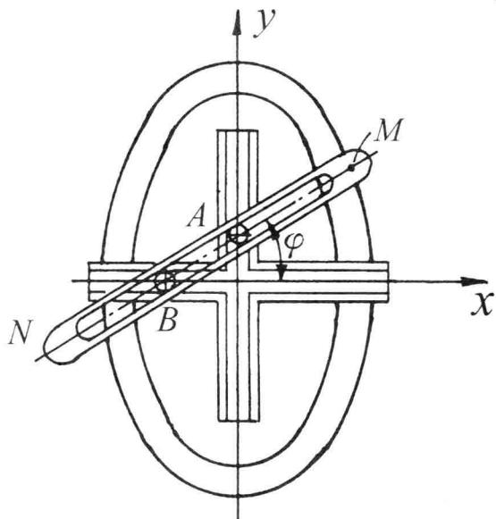
椭圆规如图所示，滑块A、B可固定在杆MN的适当位置，滑块B可在水平槽内滑动，滑块A可在铅直槽内滑动。已知 $\overline{MA}=c$ ,  $\overline{MB}=b$ , 杆MN的转动规律为 $\varphi=\omega t$ , 其中 $\omega$ 为常量。
