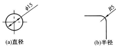
图 1-18 圆和圆弧的小尺寸的标注
