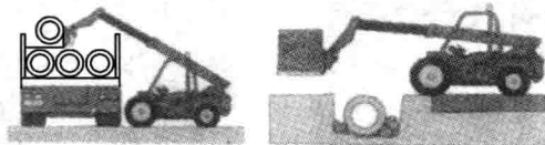
图 1-7 伸缩臂叉车作业示意图
