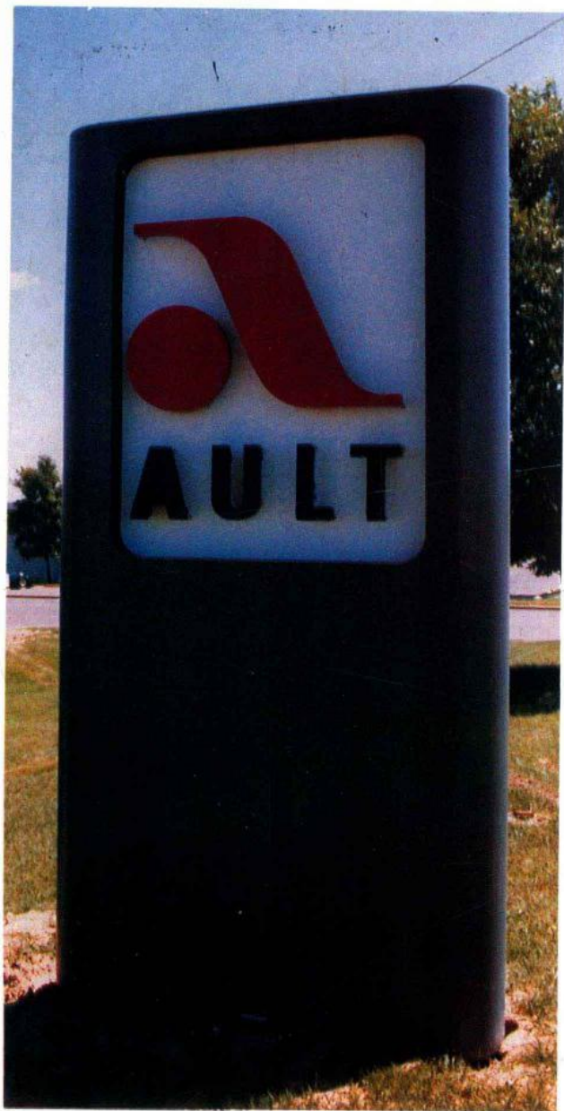
这个公司双色标识底色为白色，外框为黑色圆角长方形。晚上，红色霓虹灯光映衬在白底色上面，凹形框起遮挡作用，以免灯光散射外部。这个双面招牌用铝材料制作。
