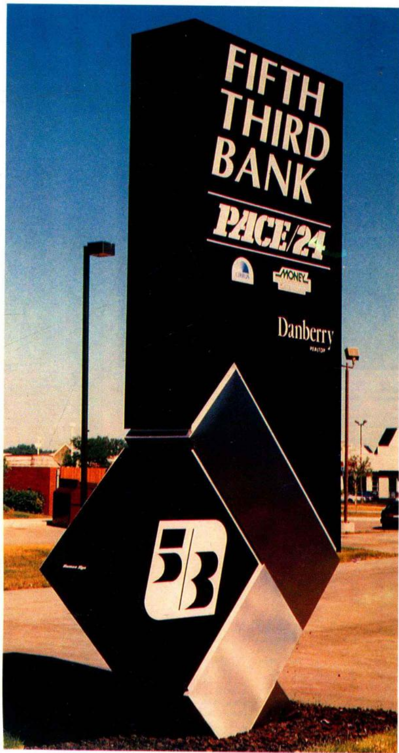
这个银行双面灯箱招牌,牌面由白色丙烯酸材料支撑,可更换的出租镶板为乙烯树脂材料,表面防护层为不锈钢材料。
