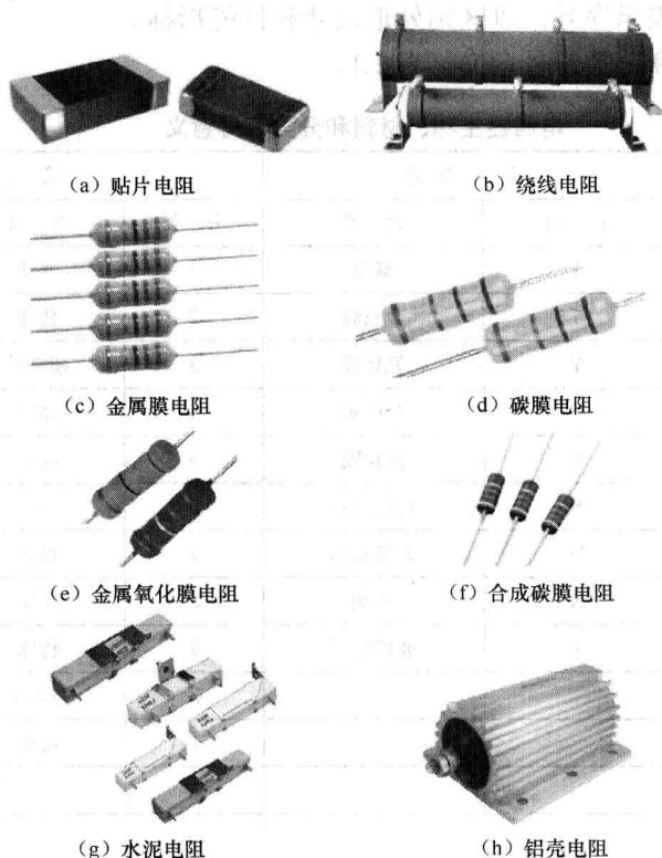
图 1.2 常用电阻器的外形
