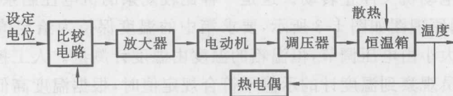
图 1-6 恒温箱自动调节过程框图
