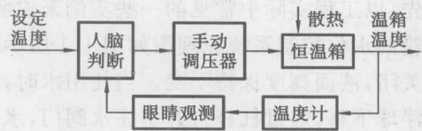
图 1-4 恒温箱人工调节过程框图
