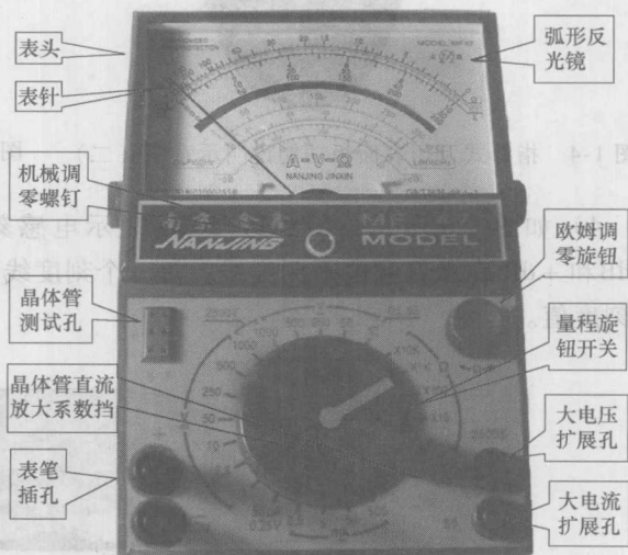
图 1-1 MF-47 型指针式万用表实物结构
