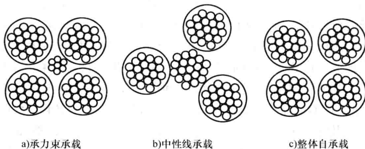
图 1-7 低压集束型绝缘导线结构图
