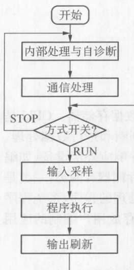
图 1.2 PLC 循环扫描的工作过程
