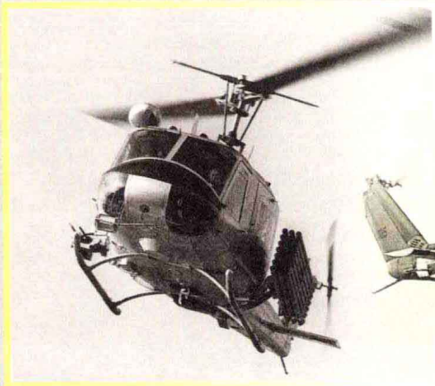
↑ 一架意大利建造的UH-1直升机，通过用两挺外挂梁上安装的机枪和21枚火箭弹的攻击，演示了其攻击能力。
