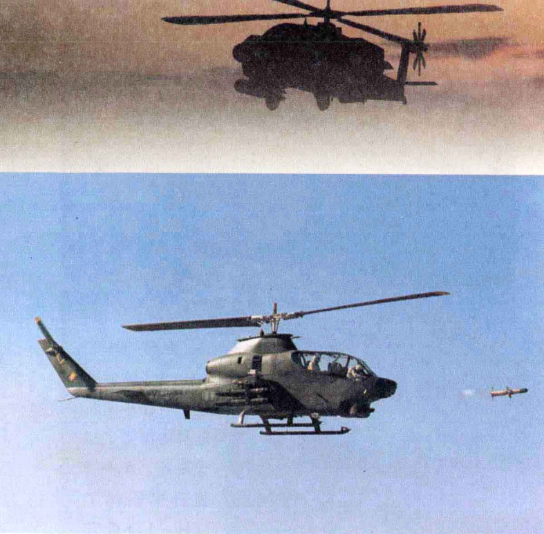
↑ 在越南战场上使用的BGM-71A“陶”(TOW)式导弹是一种有线制导反坦克导弹，其射程为3200米(2英里)。
