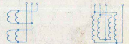
自用线圈接线图
