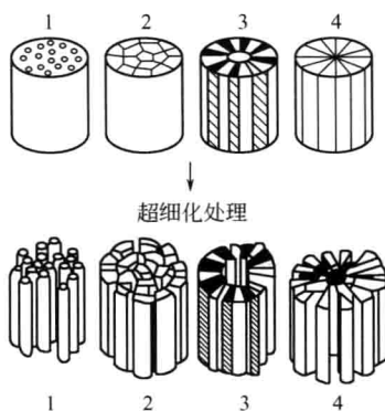
图 1-3 复合剥离法和复合海岛法纺制超细纤维
