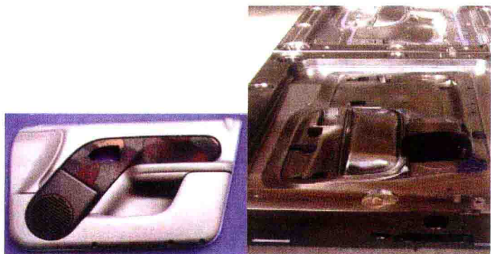
图 4.22 在织物上注射部件和纺织品背部注射技术所使用的模具（Simoldes Plasticos Lda） （a）内部门板；（b）成型区域（移动侧）
