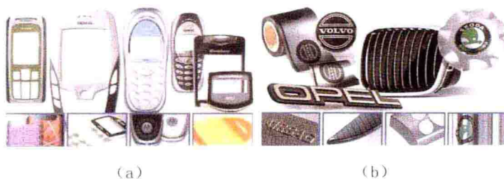
图 4.28 运用 IMD 技术生产出的部件的例子 (a) 装饰性嵌入成型；(b) 模内贴箔 (Kurz)
