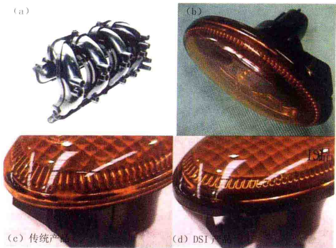
图 2.41 DSI 模塑产品的实例 (a) 模塑空气进气管；(b) 模塑车灯；(c) 传统产品；(d) DSI 产品
