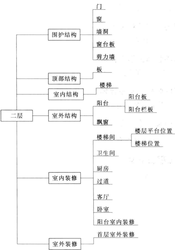
图 2-1 二层要计算的构件工程量（三、四层与其相同）
