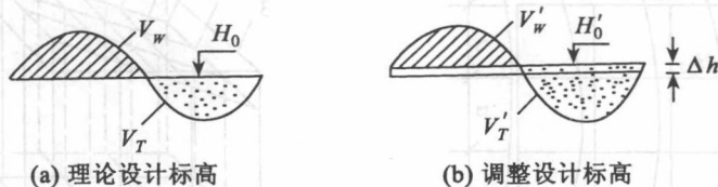
图 1.2.3 设计标高调整示意图
