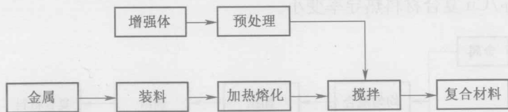
图 1-1 搅拌铸造法流程图
