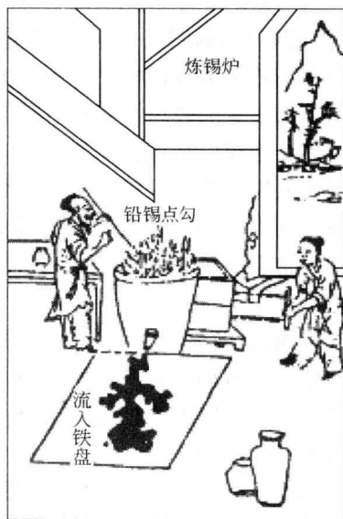
图 1-1 古代土法炼锡示意图
