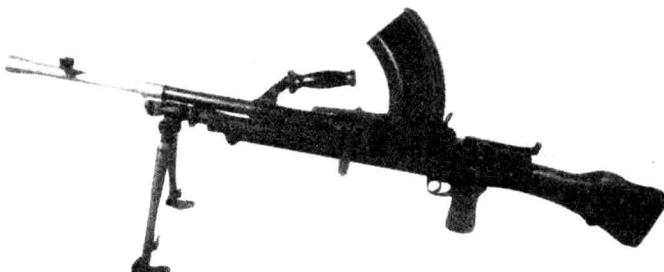
“歪把子机枪”。该机枪采用了哈其开斯机枪的导气式自动系统，有两个最显著的特点：一是采用漏斗供弹系统，在机匣的右上方有一个方形漏斗，可装6个5发弹夹。射击时，输弹机构从弹夹的下部拨弹，当弹夹上的弹射击完时，将弹夹从漏斗中抛出，下一个弹夹被推进到位，这一机构设计得非常巧妙；二是采用了向右歪的枪托，便于抵肩瞄准和射击。
