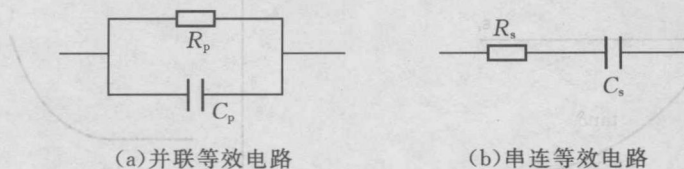
图 1.1 介质试样的等效电路
