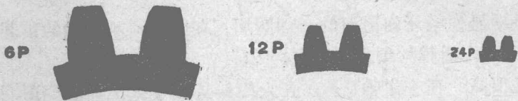
圖五 不同徑節的齒輪牙齒形狀的比較
