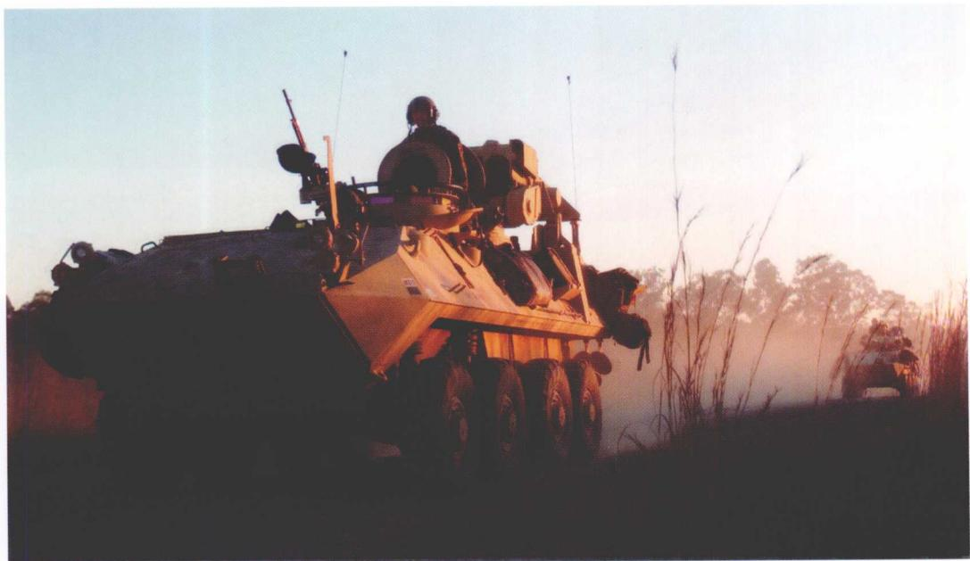
清晨，一辆配备了反坦克武器的LAV-AT全地形装甲运兵车驰骋在尘土飞扬的小路上。作为支援步兵和侦查分队的机动平台，LAV-AT主要用来对付包括坦克在内的敌方装甲车辆。图中，在LAV-AT指挥员的后方，是陶式II型反坦克导弹发射架。它可以发射两枚导线制导反坦克导弹。一辆LAV-AT可搭载16枚导弹。
