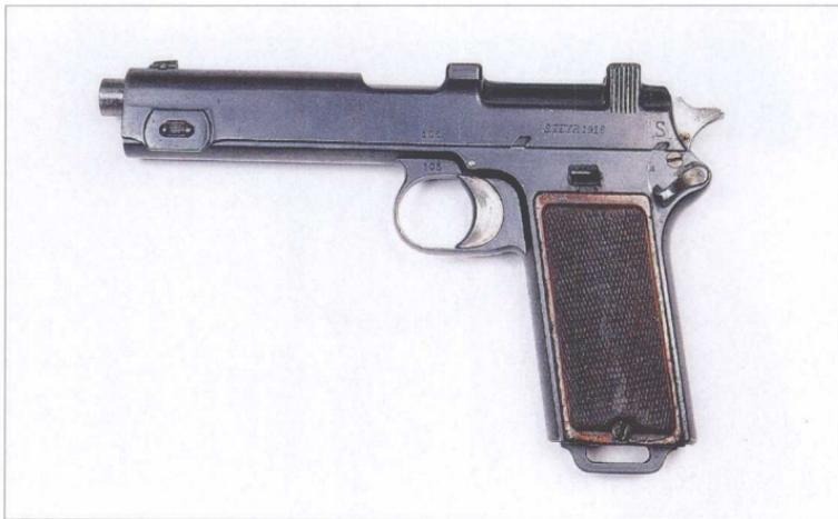
该枪是史上最出色、可靠的手枪之一，它发射奥匈帝国特有的一种枪弹。该枪最初使用弹条装弹系统，这种系统在可卸式弹匣问世前就已废弃不用。1938年，奥地利被第三帝国吞并，该制式手枪也随之改进枪管以发射9×19毫米巴拉贝鲁姆手枪弹，并在套筒左侧标有“P-08”以示与原枪区别。9毫米斯太尔手枪弹目前仍在生产。
