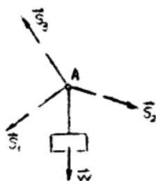
解：以节点 A 以及重物为对象，受力如图示。AB、AC、AD 杆的内力以  $\vec{S}_1$ 、 $\vec{S}_2$ 、 $\vec{S}_3$  表示，并且都假定为拉力。从此有平衡方程：
