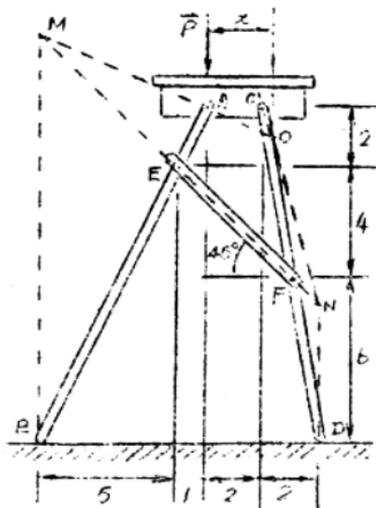
作用，如果平衡，根据三力平衡定理， $\vec{R}_A$ 的作用线必须通过M点，而 $\vec{R}_C$ 的作用线必须通过N点如图示。AM与CN相交于O点，那么，平台AC平衡时， $\vec{P}$ 必须通过O点。
