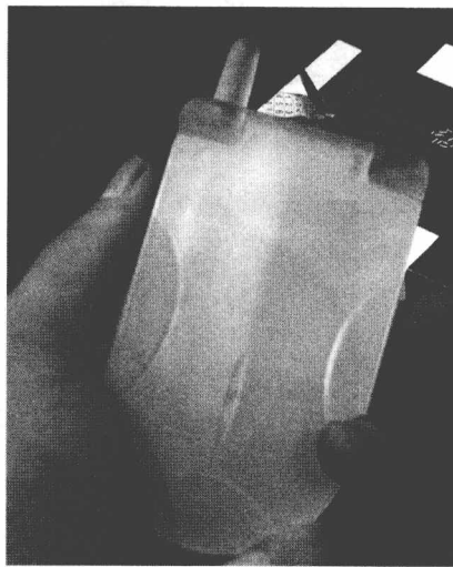
图 1-14 计算机辅助(CNC)加工的手机模型
