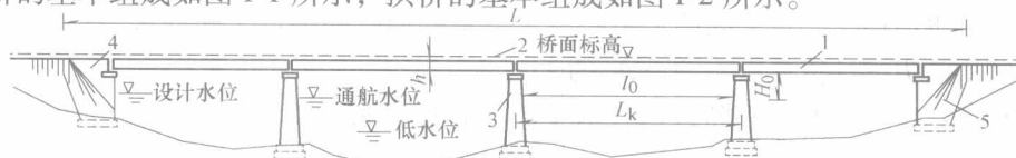
图 1-1 梁桥的基本组成
