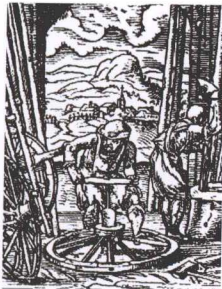
图1-19 车轮工匠的作坊。车轮匠正在制作一个盘式车轮，在钻孔制作轮毂。另一个人正在劈木材制作辐条。安曼，1568年
