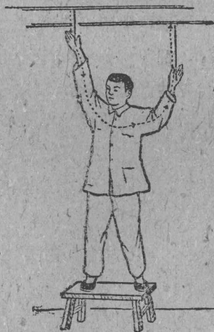
圖 4 立在木凳上,碰到两根电线,就会触电
