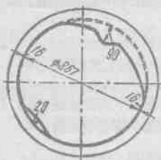
圖51-4 由於用污水補給單火管式鍋爐而造成的火管損壞引起的蒸汽鍋爐事故的發生原因和後果。
