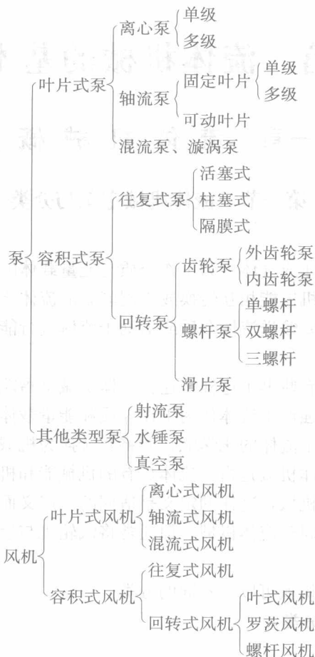
图 1-1 按不同工作机理分类的泵与风机
