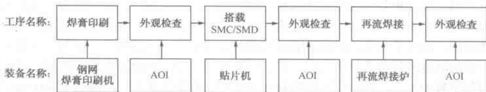
图 1.3 SMA 安装工艺过程与所用设备
