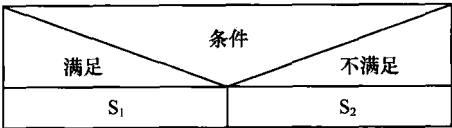
图 1.4 两路分支选择结构的结构化流程图
