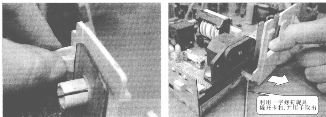
图 1-21 取出固定壳体
