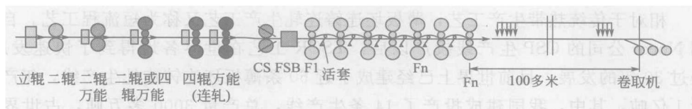
图 1.1 传统的厚板坯连铸连轧生产工艺
