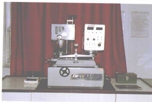
检验鞋类的耐磨试验机
