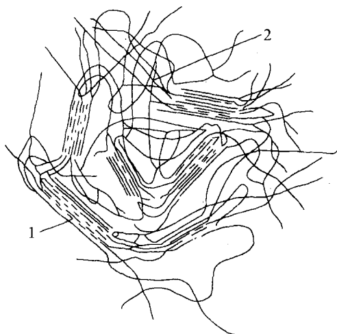
图 1.2 结晶型聚合物结构示意图
