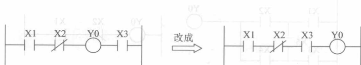
图 0-5 触点不能出现在线圈的右边
